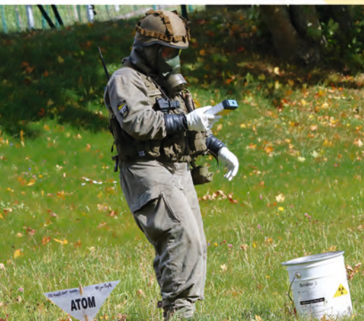
Das ABC-Simulationssystem ARGON ist eine Live-Simulation und ermöglicht das Detektieren von Kampfstoffen ohne Gefahr für die Übenden und die Umwelt. Fotos: RedTD/Sascha Harold
